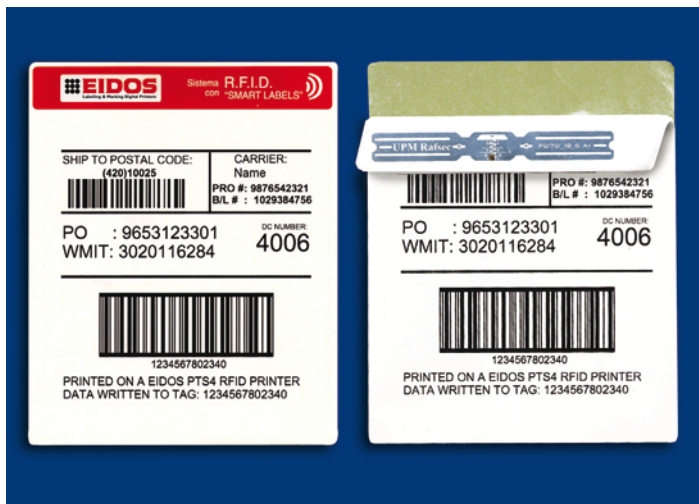
Etichetta "smart label" con evidenziatura del "tag" (circuitto elettronico dotato di memoria riscrivibile)
